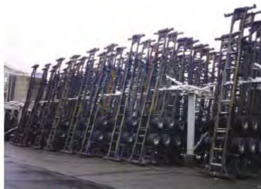
横浜シャーシターミナル協同組合の「立て掛け式駐車設備」
