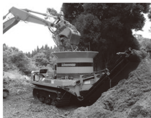
エコガーデンの共同処理施設で、木クズ・剪定クズ・芝生等をチップ化する様子
