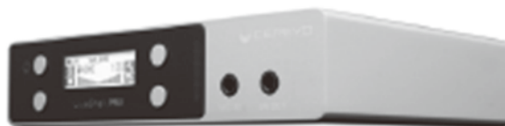
パソコンを介さずにライブ動画共有サイトで映像配信を行える映像配信機
