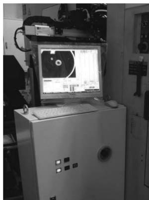
工具磨耗検査装置
