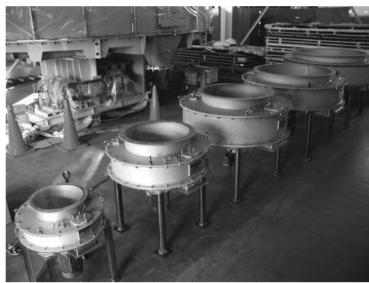
溶接ロボットで製造したサークルフィーダ
