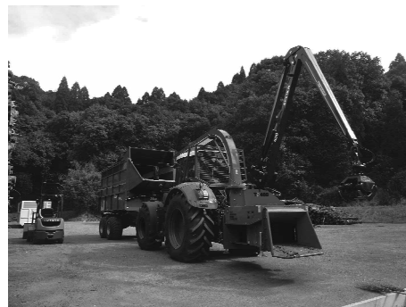
始良工場に導入したデンマーク製移動式チップパー。搬出しづらい間伐材を山林中でチップ化できる。
