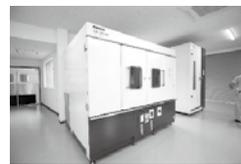
新型洗浄・脱水機、乾燥機
