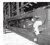
主筋自動曲げ装置
