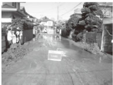
噴砂による液状化被害
